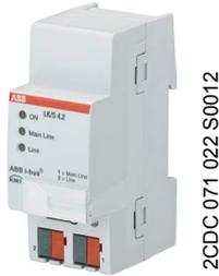
Der ABB i-bus® KNX Linienkoppler LK/S 4.2 ist ein Reiheneinbaugerät mit 2 TE Modulbreite. Er wird als Linien-/Bereichskoppler oder Linienverstärker eingesetzt. Als Linienkoppler verbindet der LK/S eine Linie mit einer Hauptlinie, als Bereichskoppler eine Hauptlinie mit einer Bereichslinie. Hierbei sorgt er für eine galvanische Trennung.
